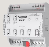
MAXinBOX FC 0-10V FAN (Ref. ZCL-FC010F) Controlador de fan coil de 2 o 4 tubos con regulación de velocidad del ventilador mediante señal 0-10VDC.*
