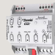
MAXinBOX FC 0-10V VALVE (Ref. ZCL-FC010V) Controlador de Fancoil de 2 o 4 tubos con válvulas de 0-10VDC y hasta 4 velocidades.
